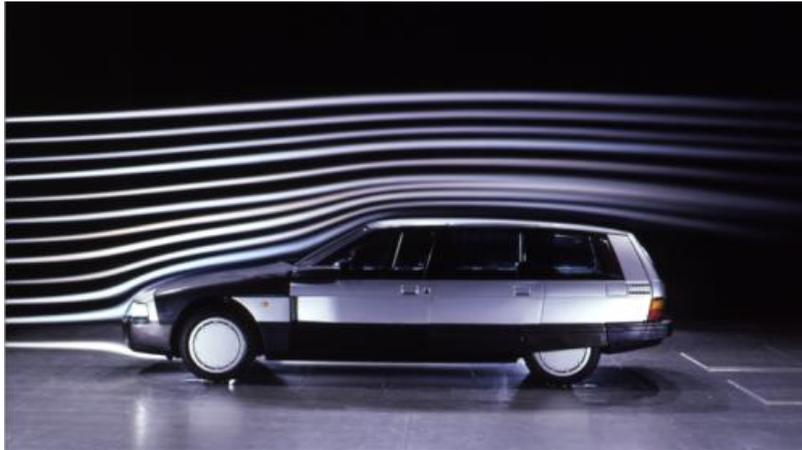
Abbildung 2.4: Die Zugabe von Rauchpartikeln erlaubt Rückschlüsse auf den Strömungsverlauf.
