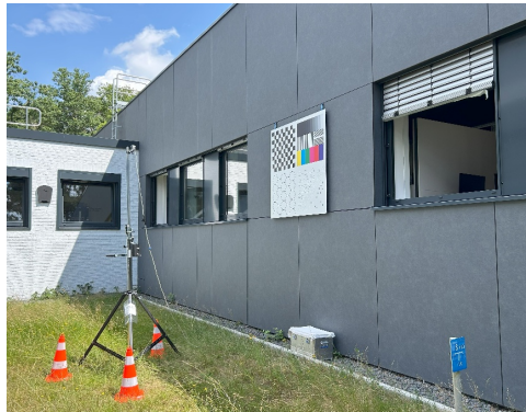
Abbildung 5.2.: Praktischer Versuchsaufbau zur Generierung des realen Datensatzes (1,5*1,5m große Aluplate mit Kalibrierungsmuster, GoPro HERO11 Black als Kamera)
