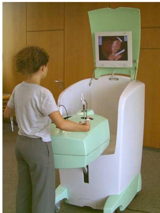
**Abb.16:** Training eines endoskopischen Eingriffs an den Nasennebenhöhlen mit VS One [VESWeb]
