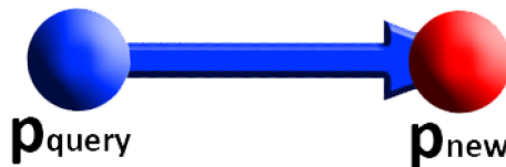
Abbildung 2.5: Euler-Integration: Ein neuer Punkt wird aus dem alten Punkt und dessen Vektor bestimmt. [Köh12]
