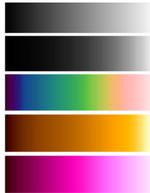
Abbildung 3.2: Farbskalen. In der Reihenfolge von oben nach unten: Grauwertskala, linearisierte Grauwertskala, Temperaturskala, modifizierte Regenbogenskala und Magentaskala.
