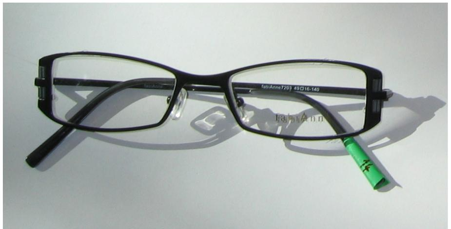
Die exakte Vermessung der Innenkontur der Brillenfassung ist notwendig, um die Brillengläser passgenau einsetzen zu können. Die Abmessungen der Brillenfassung sind oft aufgrund fehlender Konstruktionspläne nicht bekannt. Zudem besitzen, zunehmend in Billiglohnländern hergestellte, Brillenfassungen auch innerhalb einer Modellreihe eine Formvarianz. Bestehende, mechanische
