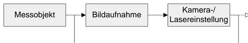
Der Regelkreis kann die Belichtungszeit der Kamera und/oder die Intensität des Lasers zur Ermittlung der optimalen Laserlinienabbildung nutzen. Die beiden Möglichkeiten werden im nächsten Abschnitt gegenübergestellt.
