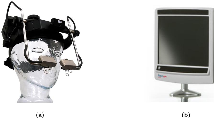
**Abbildung 2.6:** Abbildung (a) zeigt den kopfbefestigten Eye-Tracker EYELINK I der Firma SR Research. In Abbildung (b) ist das desktopplatzierte System MYTOBII P10 der Firma Tobii nach [TOBII EYE TRACKING & EYE CONTROL] dargestellt.
