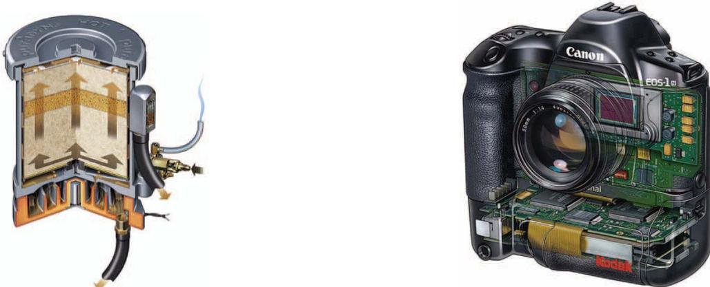
**Abb. 37:** Eine Cut-away-Ansicht eines Ölfilters [35] (links). Eine Ghosting-Ansicht einer Kamera [35] (rechts).
