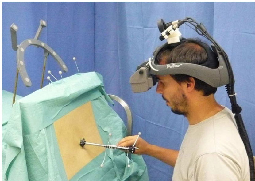
Abbildung 3.4: Versuchsaufbau der Nutzerstudie für die virtuelle Endoskopie nach Bichlmeier et al.; Quelle: [Bic10]
