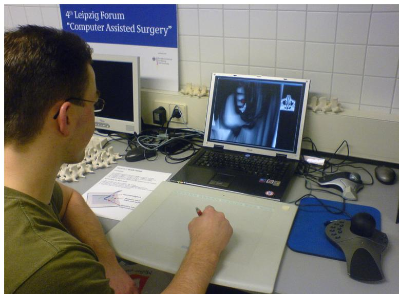
Die Evaluierung fand am „ICCAS“, dem Innovations Center für computergestützte Therapieplanung der Universität Leipzig, im Februar 2007 statt. Die Abbildung 5.6 zeigt den Versuchsaufbau der Evaluierung und demonstriert einen Probanden, welcher eine virtuelle Kamerafahrt mit Hilfe des Grafik-Tablets durchführt.
