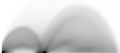
Abbildung 4.9.: Grauwertdarstellung des Intensitäts-/ Gradientenstärke-Histogramms eines CT-Schädel Datensatzes. Die Abzisse trägt die Intensität ab, während die Ordinate die Gradientenstärke repräsentiert.
