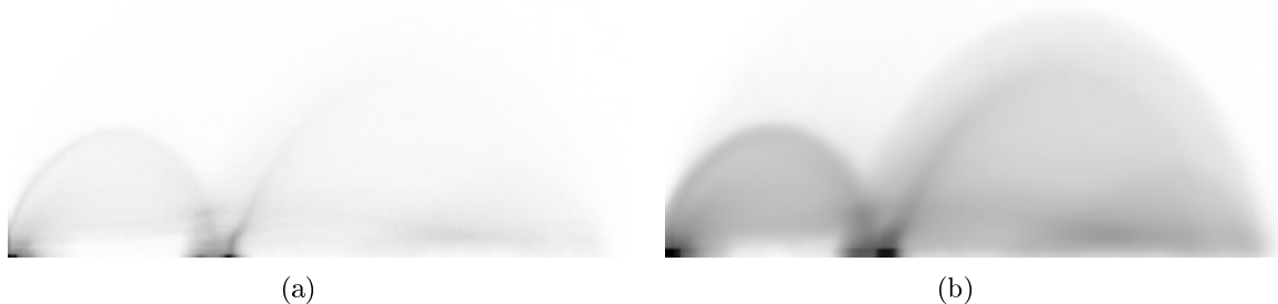
Abbildung 5.10.: Auswirkung der k -Nachbarschaft auf das 2D-Histogramm eines CT-Datensatzes. Je dunkler das Pixel im Bild des Histogramms, desto mehr Voxel wurden dem betreffenden Bin zugeordnet. Durch Verwendung der k -Nachbarschaft (b) wird die Bogenstruktur im Intensitäts-/Gradientenstärke-Histogramm erkennbar.
