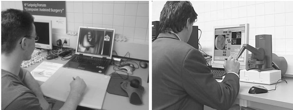
Abbildung 6: Aufbau der Testsysteme am Innovation Center for Computer Assisted Surgery (ICCAS). links: Vergleich der kombinierten Eingabegeräte, rechts: Evaluierung der haptischen Steuerung mit dem Phantom.
