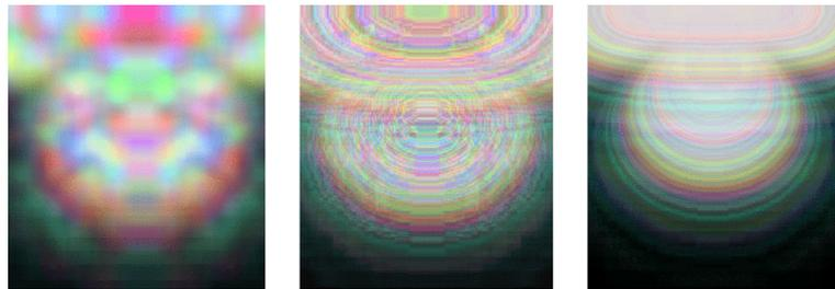
**Abbildung 3.9:** Klassifikationsverfahren im Vergleich. Die Pre-Klassifikation (links) hat das schlechteste Ergebnis, während die anderen beiden Post-Klassifikationen höherwertig sind. Rechts im Bild wurde *Pre-Integrated Classification* angewandt.
