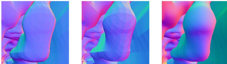
**Abbildung 4.11:** Ergebnisse der Normalenerstellung: Gradient aus Tiefenpuffer (links), Übergangspunkte im Kameraraum (mitte) und Zentraler Differenz im Volumen.
