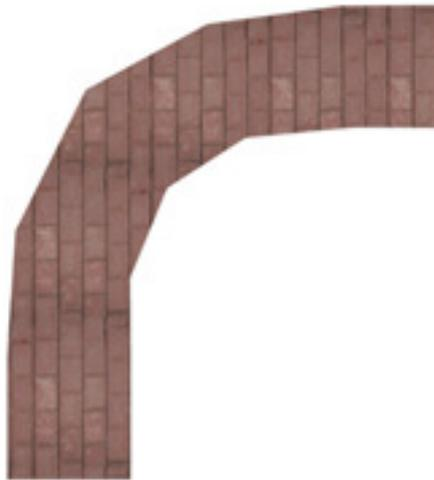
Abbildung 4.6: Einfaches *mapping* einer Textur auf ein gekrümmtes Straßenpolygon
