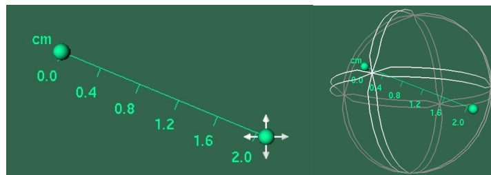
Abb. 3: Manipulation eines 3d-Lineals: Links: Translation eines Endpunktes zur Größenänderung des Lineals. Rechts: Rotation des Lineals durch einen Trackball-Manipulator. Die Manipulatoren werden jeweils im dazugehörigen Dialog ein- und ausgeschaltet.
