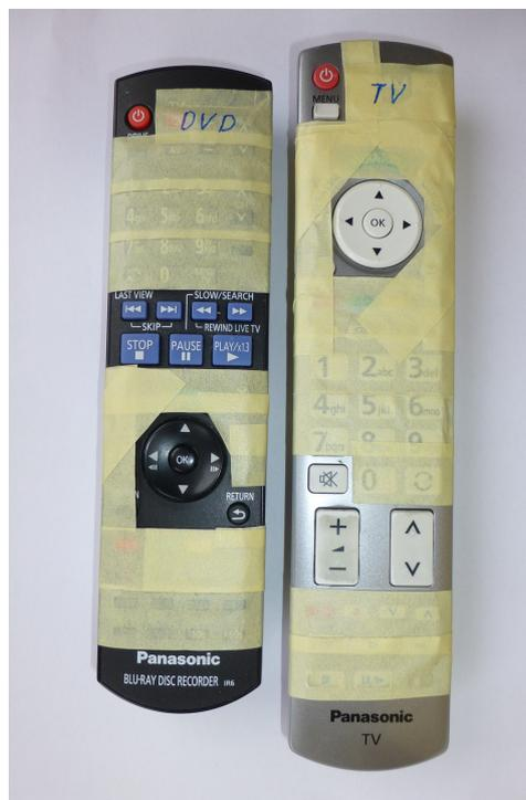
**Abbildung 8.3:** Ein wichtiger Aspekt bei der Optimierung von User-Interfaces ist die Reduktion auf das Wesentliche. Durch Abdecken von nicht / selten benötigten (Spezial-)Tasten wurde die Bedienbarkeit dieser Fernbedienungen für die beehrte Zielperson deutlich verbessert.
