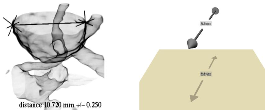
**Abbildung 5.2:** Approximative manuelle Abstands-Bestimmung. *Links:* Interaktives 3D-Mess-Widget mit getrennter Anzeige des Messwertes samt modalitätsbedingter Ungenauigkeit, beide mit überraschend vielen Nachkommastellen angegeben (Quelle: [Hastreiter u. a. 1998]. © Nachdruck mit freundlicher Genehmigung von Springer). *Rechts:* Distance Line (Quelle: [Preim u. a. 2001]. © Nachdruck mit freundlicher Genehmigung von Springer).
