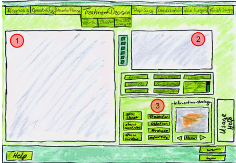
Abb. 6.8 GUI-Aufbau des Punktes Analyse, 1: Anzeigefläche für Illustrationen bzw. Textausgabe, 2: Nebenansicht für 2d/3d-Sicht, 3: Auswahl der Interventionsstrategien bzw. Interventionsverfahren und Schaltflächen für die Speicherung der Analyse.
