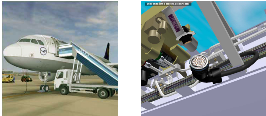
Abbildung 1: Schlauchobjekte in Trainingsszenarien zur Qualifizierung von Servicetechnikern am Airbus 320; Tankschlauch an der Unterseite des Flugzeugrumpfes (links) und Kabel (schwarz) mit Steckverbinder innerhalb der Tragfläche (rechts) [Sch05]
