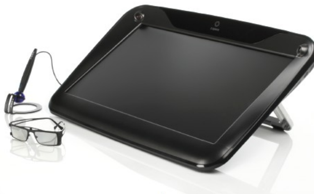
Abbildung 10: zSpace 100 Modell mit Brille und Stylus (Bildquelle: techbriefs 1 ).
