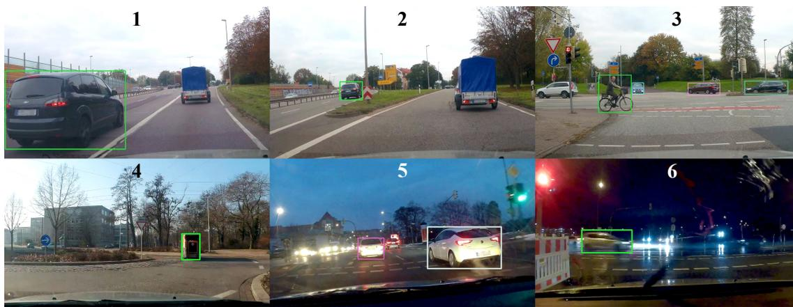
Abbildung 6.1: Übersicht der Szenen. (1) kleiner werdendes Fahrzeug, (2) teilweise verdecktes Fahrzeug, (3) mehrere verdeckte Fahrzeuge, (4) Belichtungsunterschiede, (5) Dämmerung und langer Verkehrsfluss, (6) Nacht und Regen
